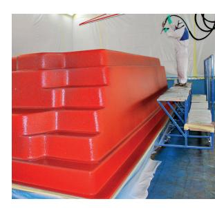
In der letzten Phase der Herstellung wird das Becken in einer geschlossenen Kabine einer Wärmebehandlung ausgesetzt. Dadurch werden die verwendeten Harze ausgehärtet, wodurch die volle Widerstandsfähigkeit des Materials gewährleistet wird.
